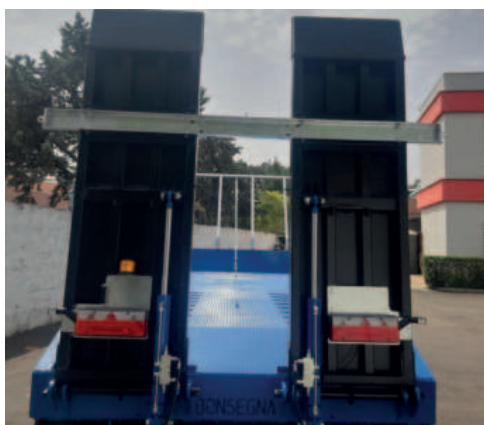
Rampe idrauliche posteriori
