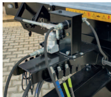
Freno idraulico tandem
