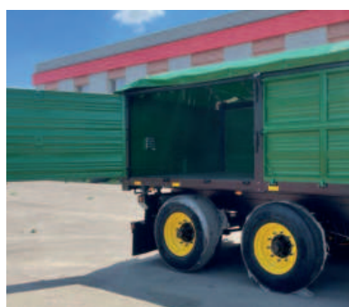
Apertura a bandiera sponda e soprasponda laterale
