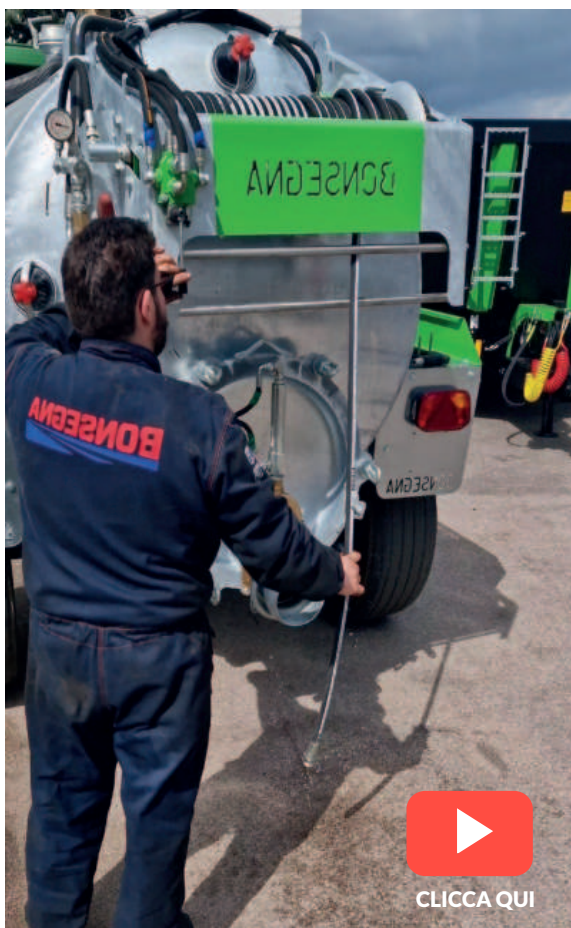
Naspo posteriore ad azionamento idraulico
