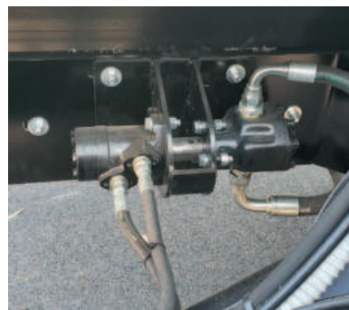
Ribaltamento con pompa e motore idraulico
